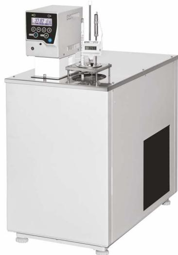
Переливной жидкостный низкотемпературный термостат **ТЕРМОТЕСТ-100** предназначен для поддержания заданной температуры при поверке и калибровке различных термометров и датчиков температуры.
