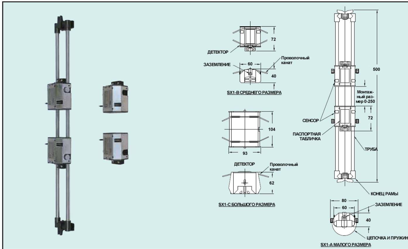
Детекторы ультразвукового расходомера серии SX1 образуют пару с преобразователями серии UXF1, использующими метод измерения разницы времени прохождения потока при измерениях расходов в трубах. Два ультразвуковых сенсора устанавливаются на наружной части трубы. Каждый из сенсоров передает ультразвуковой импульс на противоположный сенсор. Разница во временах прохода двух волн используется для расчета скорости потока.
