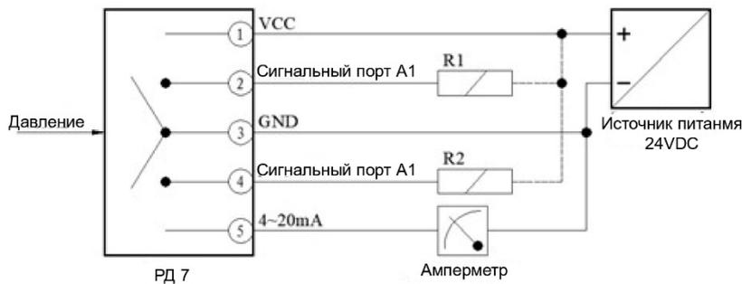
Нагрузка R1 (или R2) должна быть подключена между сигнальным портом A1 (или A2) и портом VCC. Давление срабатывания для каждого сигнального порта может быть задано отдельно. Нагрузка на R1 (R2) - ≤1000mA.
