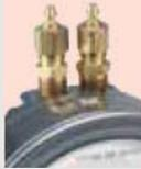
**Фитинг для стравливания А-314** – Используется для более легкого, безопасного удаления захваченного воздуха при работе дифференциального манометра с жидкостями. Также полезен для слива конденсата при установке в нижней части системы. Для открывания просто ослабьте шестигранную гайку. Материал – прочная латунь.
