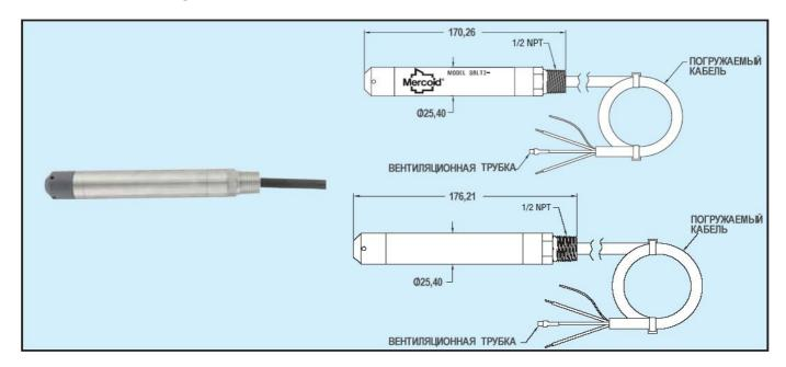
Погружаемые датчики уровня серии SBLT2 и SBLTX производятся для безаварийной работы без обслуживания в течение нескольких лет в самых тяжелых условиях эксплуатации. Глубина погружения до 240 метров. Датчик делает замер высоты жидкости над его положением в резервуаре относительно атмосферного давления. Датчик состоит из пьезорезистивного чувствительного элемента, установленного в корпус из стали 316 SS. Пулевидный наконечник защищает диафрагму от повреждения.
