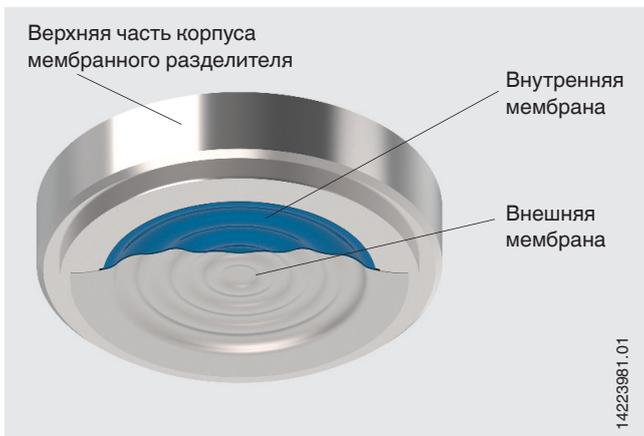
Патентованная конструкция WIKA с двумя мембранами (патент № DE19949831) является решением для критичных процессов, где не допускается ни попадание измеряемой среды в окружающую среду, ни попадание заполняющей жидкости в измеряемую среду.
