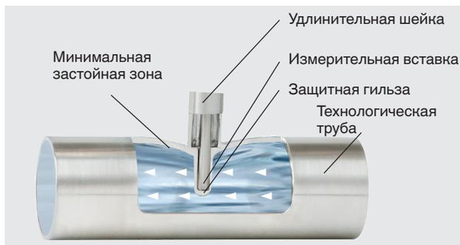
Запатентованная асептическая конструкция проточного корпуса TW61 позволяет свести к минимуму застойные зоны, выполнить инвазивные измерения температуры и за счет самодренажа легко выбрать монтажное положение.
